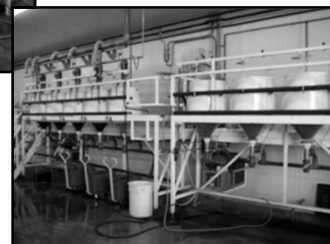
Equipamento comercial para condicionamento osmótico (Bradford)
